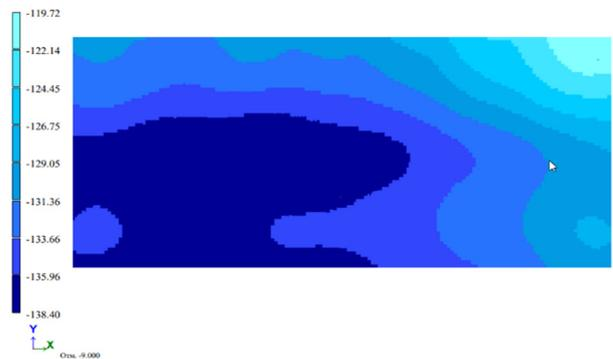
Рис.3. Общий вид расчетной схемы ЖК №1 (г.Москва) и мозаика перемещений фундаментной плиты.
