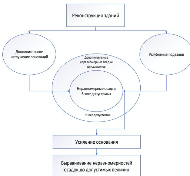
Рисунок 1 – Влияние реконструкции на грунтовое основание и осадку фундаментов
