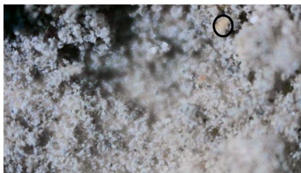
Рис. 2. Микроструктура легкого бетона, на основе кукурузных отходов и добавок из содосульфатной смеси, шлака, золы-уноса и 7% портландцемента от массы шлака
