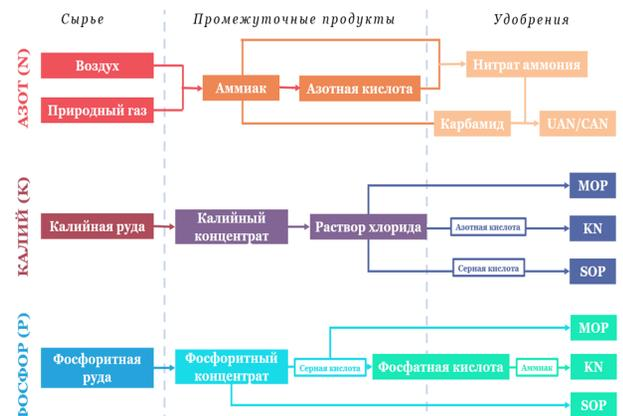
Рисунок 12 – Схема производства удобрений [3]
