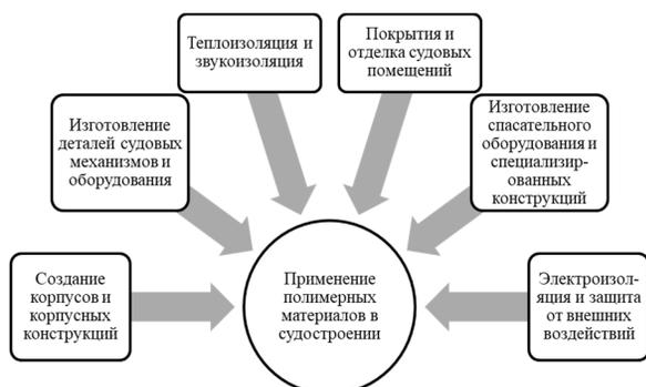
Рисунок 1 – Направления использования полимерных материалов в судостроении, составлено по данным [3].
